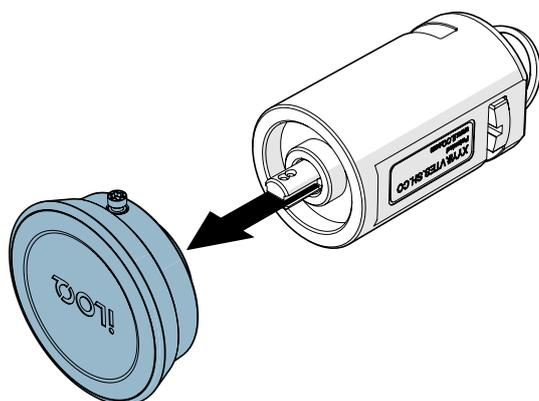
3. Schieben Sie den neuen Leseknauf so auf den Zapfen, dass das Schraubenloch in die gleiche Richtung zeigt wie die zwei Schlitz zur Einstellung des Knaufs im Zapfen.
