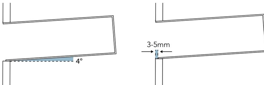
Die korrekte Positionierung des Rohrtresorzylinders F50S im Rohrtresor ist in der nachfolgenden Abbildung dargestellt.
