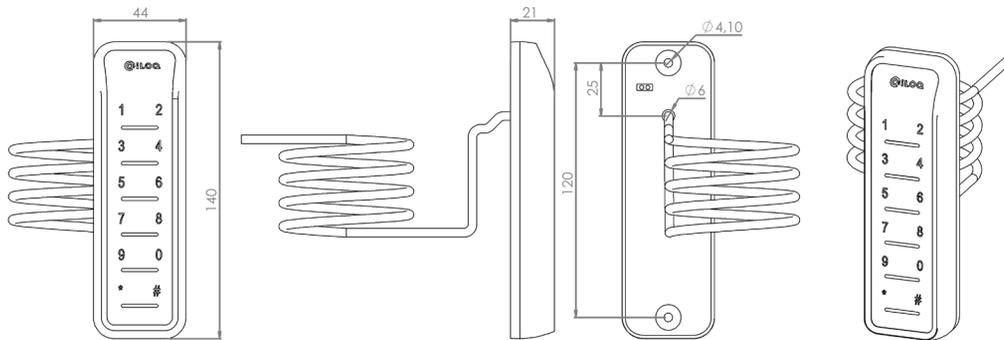
El lector RFID es un dispositivo ubicado cerca de una puerta. Está conectado al bus del LECTOR RS-485 del módulo de la puerta y no tiene otras conexiones. El lector RFID se utiliza para controlar una cerradura eléctrica mediante una llave iLOQ equipada con una etiqueta RFID iLOQ.
