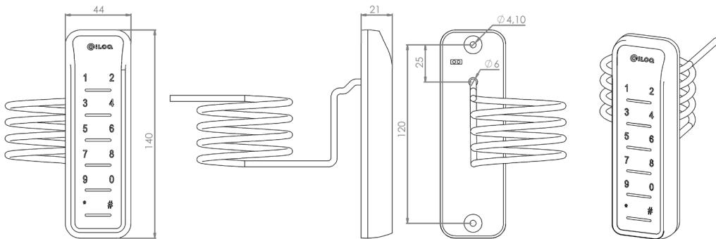
RFID-läsaren är en enhet som är belägen i närheten av en dörr. RFID-läsaren är ansluten till dörrmodulens READER RS-485. Den har inga andra anslutningar. RFID-läsaren används för att styra ett elektriskt lås med en iLOQ-nyckel utrustad med iLOQ RFID chip.
