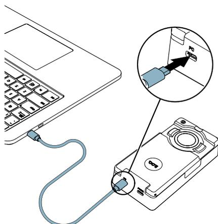
2. Si necesita programar cilindros con llave K5S, conecte el cable de programación A00.17 al puerto PROG del adaptador.
