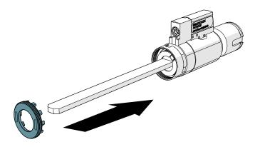
11. Insérez l'outil d'installation de la couronne et tournez-le dans le sens des aiguilles d'une montre jusqu'à ce qu'il s'abaisse.
