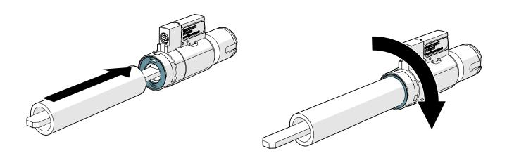
12. Tournez légèrement l'outil d'installation de la couronne dans le sens inverse des aiguilles d'une montre jusqu'à ce qu'il s'arrête.
