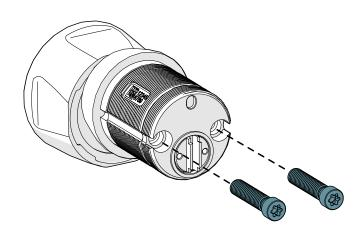
5. Fixez la came à mortaiser au cylindre à l'aide de deux vis T6 (couple maximal de 0,5 Nm).
