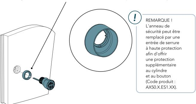
3. Alignez les deux vis avec les trous de la plaque de montage et serrez-les pour fixer le cylindre en place.
