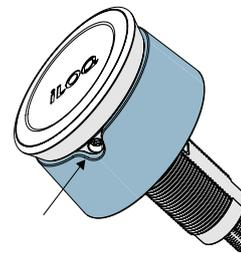
2. Introduzca el cuerpo del cilindro por el orificio de la puerta.
