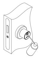
Después de 10 000 usos, limpie los rollos de contacto ligeramente con un paño de algodón sin pelusa. Rocíe una pequeña cantidad de lubricante de larga duración CRC (con PTFE) en los rodillos de contacto.
