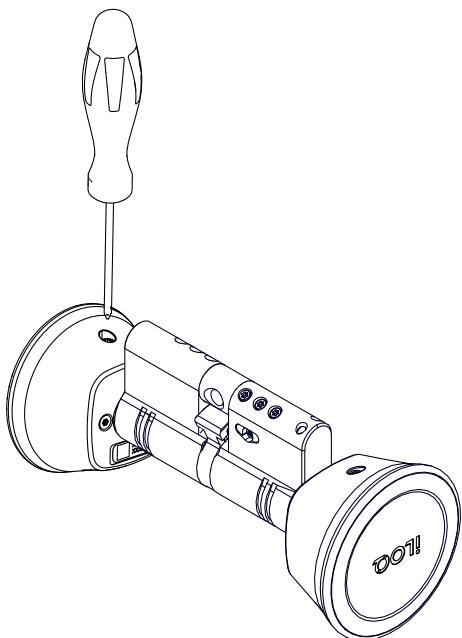
2. Fjern den løsnede antennan fra sylinderen.
