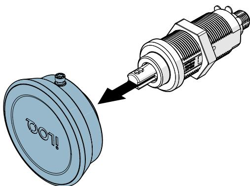
3. Potisnite nov gumb čitalnika na vrat, tako da je luknja za vijak obrnjena v isto smer kot dve nastavitevni reži gumba na vratu.
