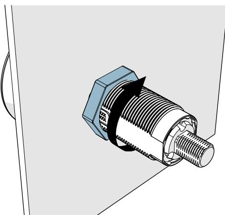
3. Namestite zapah, zaklepno podložko in matico za pritrditev zapaha (navor 1 Nm).
