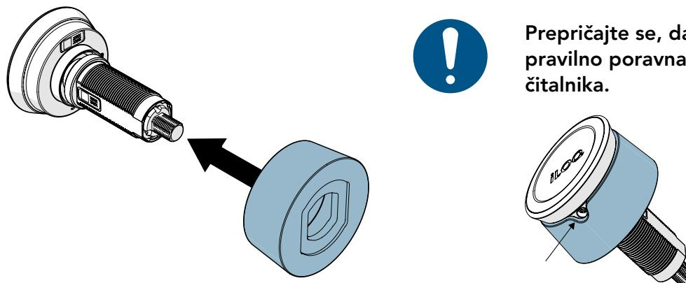
Prepričajte se, da je zareza v ščitu pravilno poravnana z vijakom v gumbu čitalnika.
