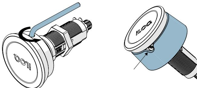
2. Odstranite gumb čitalnika z vratu cilindra.
