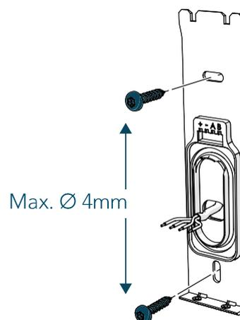
2. Schließen Sie das Kabel an den Schnellverbinder an: Sie können die Halterung des Verbinders, die sich an der Halterung befindet, beim Anschließen der Drähte verwenden, da sie Ihnen hilft, die richtigen Verbindungen und die richtige Kabellänge herzustellen. Drücken Sie den Stecker mit einem Schraubendreher, um das Kabel anzuschließen. Achten Sie darauf, die Drähte vor dem Anschließen ausreichend zu isolieren (10 mm empfohlen).
